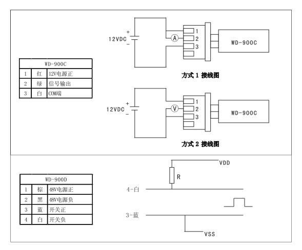
注: 传感器检测头未检测到液体时,开关闭合; 反之开启。传感器输出开关电平信号时可按照 "方式2图"连接,图中 VDD 电压可根据需要在  $5\sim30$ V 内选定,R 为限流电阻其值选定应 控制回路电流在 10mA 以内,通常选用 1mA;当 VDD 选用 5,R=5K 时,输出1mA。高电平约 5V,低电平小于 0.5V。
